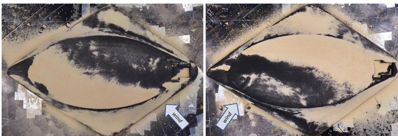
Рисунок 18 – Физическое моделирование снегонакопления для направлений ветра 144° (слева) и 213° (справа)
